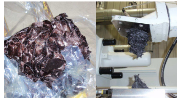
Unausgehärteter Prepreg-Verschnitt wird direkt zu Pressmassen verarbeitet.
